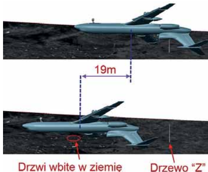
Rys. 49. Położenie samolotu w momencie mijania drzewa „Z” i położenie samolotu, kiedy znajduje się nad miejscem znalezienia drzwi wbitych w ziemię.
