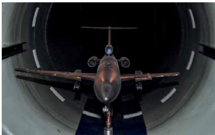
Rys. 25. Model samolotu w tunelu aerodynamicznym Instytutu Lotnictwa.
