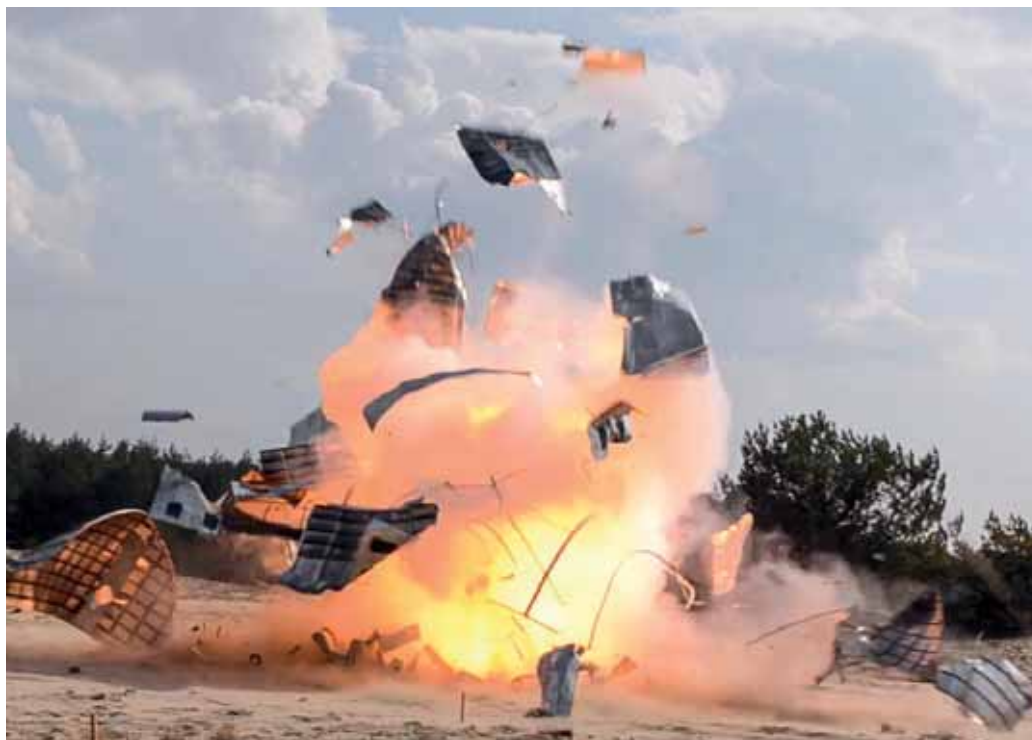
Rys. 52. Wybuch ładunku termobarycznego w modelu części pasażerskiej samolotu.
