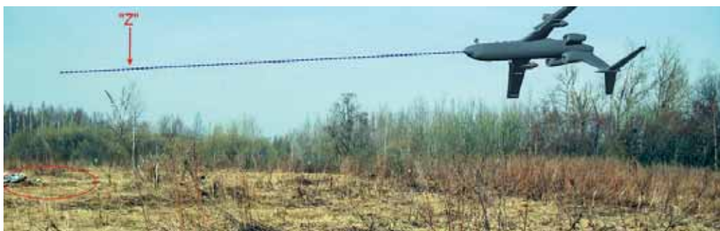
Rys. 31. Ścieżka lotu Tu-154M od ulicy Kutuzowa w stronę miejsca katastrofy nad drzewem oznaczonym literą „Z”.
