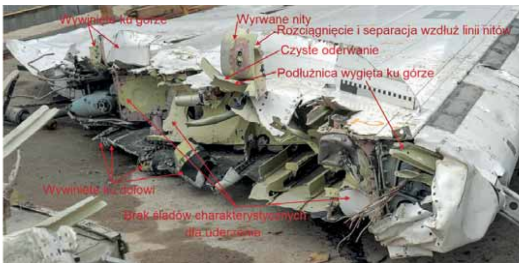
Rys. 21. Widok zniszczonego miejsca separacji końcówki odejmowanej części lewego skrzydła Tu-154M.
