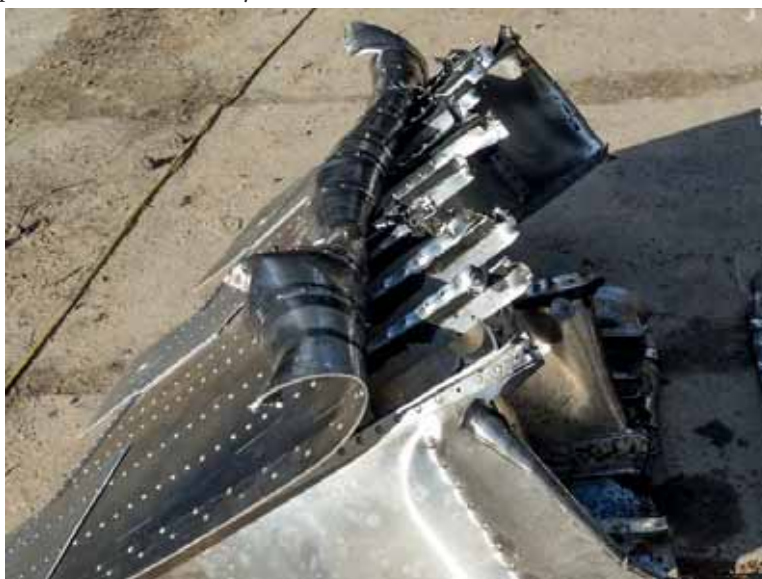
Rys. 23. Skala 1:1. Efekt eksperymentu rozcięcia modelu skrzydła z paliwem przy użyciu materiału wybuchowego.
