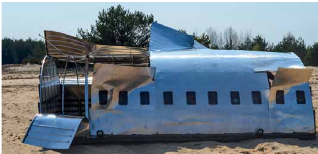
Rys. 51. Wybuch paliwa lotniczego w modelu części pasażerskiej samolotu.
