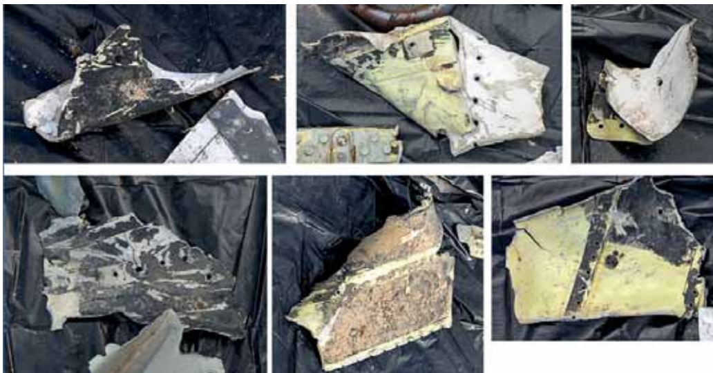
Rys. 10. Odłamki poszycia spodniego wywinięte na zewnątrz konstrukcji.
