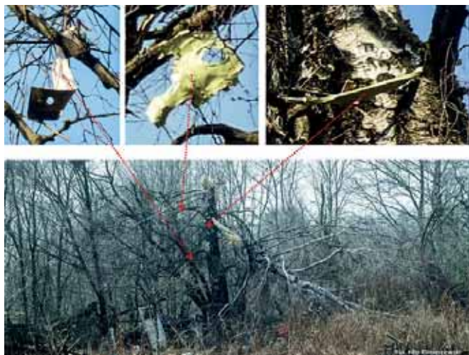
Rys. 4. Zidentyfikowane odłamki odejmowanej części lewego skrzydła wiszące 10.04.2010 r. na gałęziach (bb).
