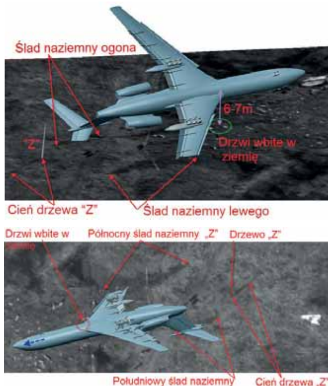
Rys. 50. Moment uderzenia samolotu w ziemię.
