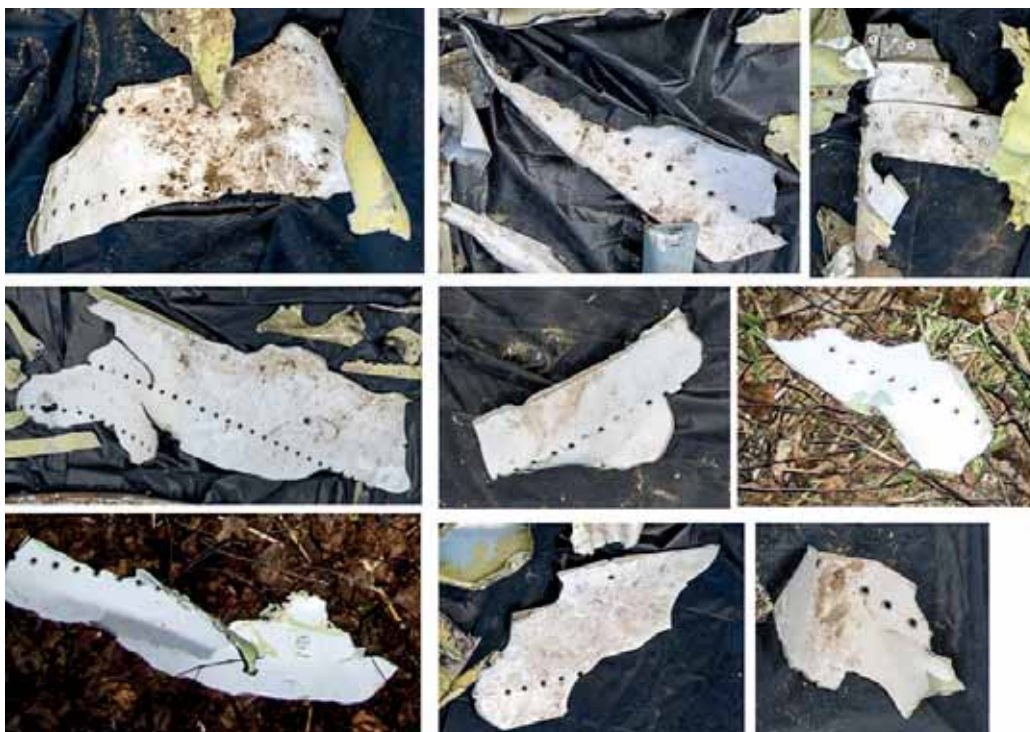
Rys. 9. Odłamki poszycia wierzchniego wywinięte na zewnątrz konstrukcji.
