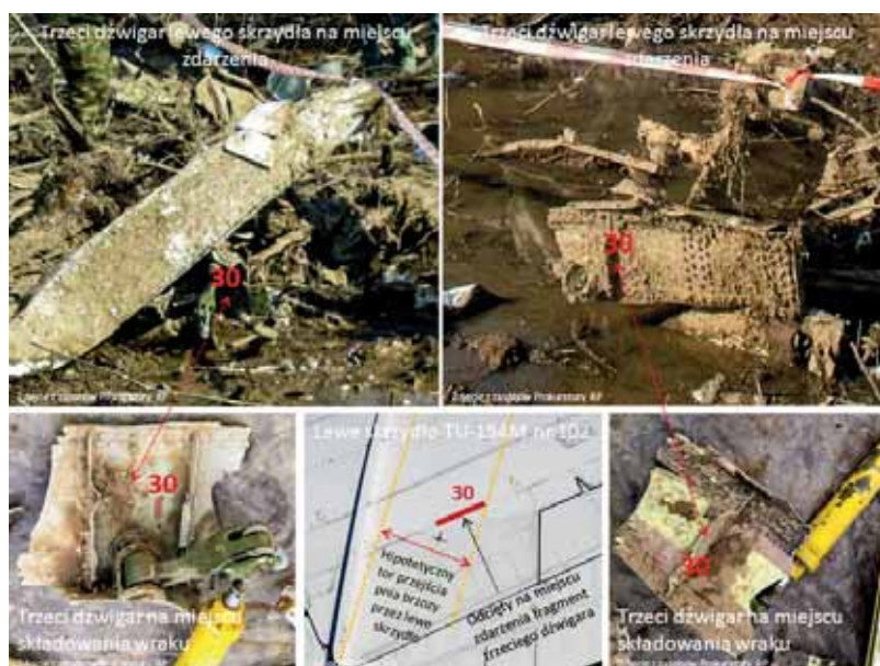
Rys. 15. Widoki tego samego fragmentu dźwigar nr 3 odejmuwanej części lewego skrzydła na głównym polu szczątków i miejscu składowania odłamków.
