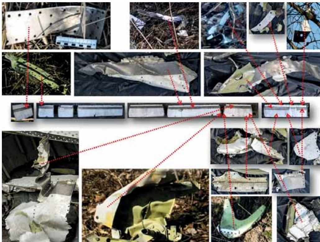
Rys. 16. Miejsca odłamków noska w konstrukcji odcinanej części lewego skrzydła wg rekonstrukcji Podkomisji.
