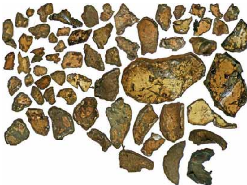
Rys. 33. Część zebranych odłamków ze śladami oddziaływania termicznego.
