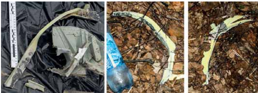
Rys. 8. Odłamki podłużnic wywiniętych na zewnątrz konstrukcji.
