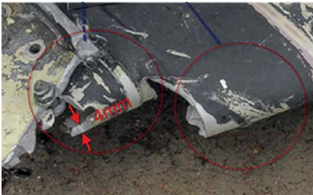
Rys. 22. Przybliżenie zdjęcia z Rys. 21 z uwidocznieniem łoków powybuchowych.
