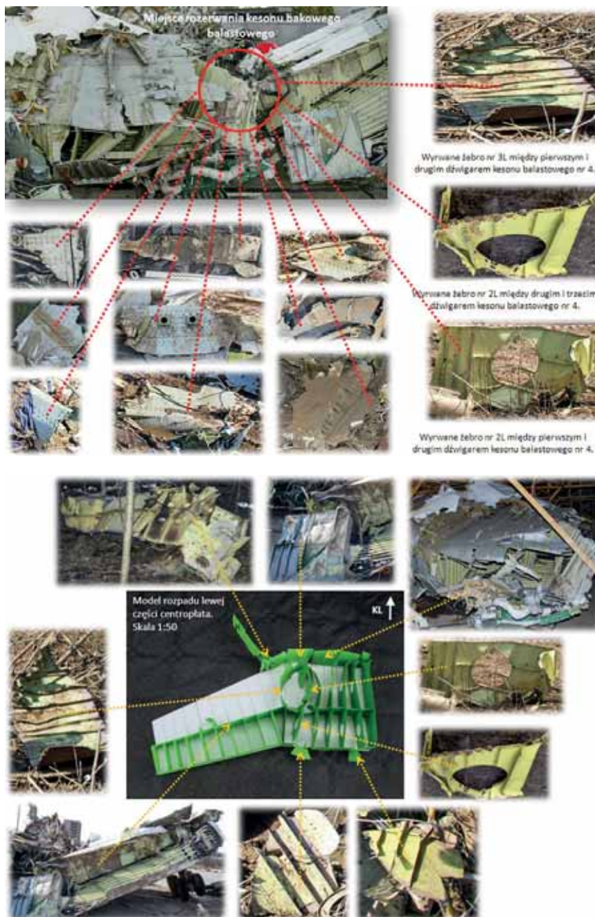
Rys. 38. Miejsce rozerwania kesonu balastowego. Opracowanie własne Podkomisji.
